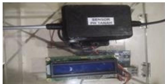
Gambar 6. Prototype alat pengukur ph tanah
